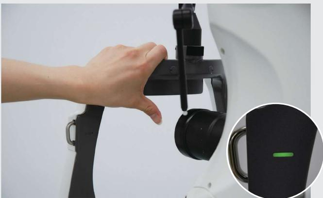
Die stabile Kopfstütze bietet eine einfachere Patientenausrichtung, während die LED-Augenhöhenmarkierung das Testen in dunklen Räumen erleichtert.
