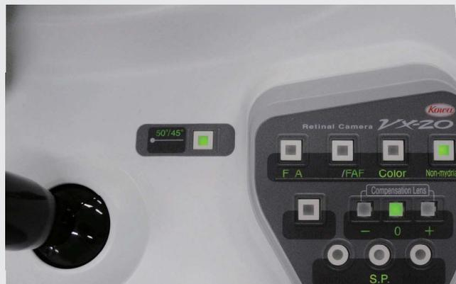
Das Bedienfeld für die Kowa VX-20 wurde entwickelt, um die Bedienerfreundlichkeit zu verbessern und alles für den Anwender in Reichweite zu halten. Das Einschwenken der Linse zur vergrößerten Aufnahme ist mit nur einem Knopfdruck machbar.
