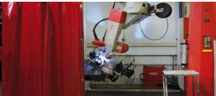
CNC-Schweißen CNC welding
