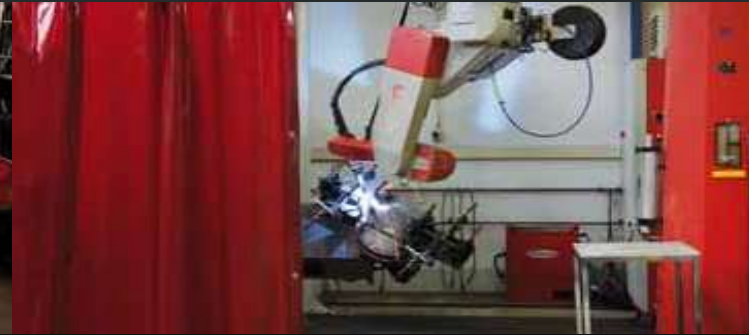
CNC-Schweißen CNC welding
