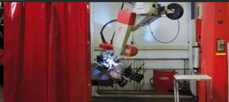
CNC-Schweißen CNC welding
