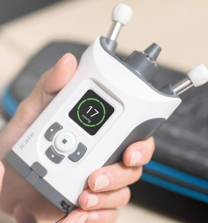
Le tonomètre iCare HOME2 utilise la même technologie de rebond que les tonomètres iCare utilisés dans les cliniques. iCare HOME2 peut être facilement utilisé par les patients dans le cadre de leur routine quotidienne.
